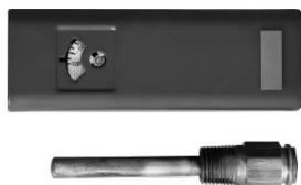
Ce dispositif limite la température de l'eau produite par la chaudière et arrête celle-ci en cas de température élevée. Il dispose d'une fonction de réinitialisation manuelle et est conforme aux exigences de la directive CSD-1.
