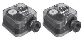
Ces dispositifs surveillent la pression du gaz et arrêtent la chaudière si la pression du gaz est trop basse ou trop élevée. Ils disposent d'une fonction de réinitialisation manuelle et sont conformes aux exigences de la directive CSD-1.
